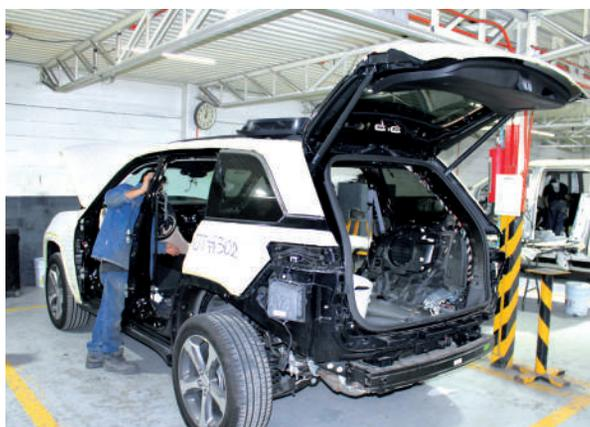
Para Abate, el blindaje de un vehículo es un proceso artesanal, ya que se desarma por completo para implementar los distintos materiales; se retiran puertas, cristales, asientos, tablero, alfombra, suspensión, etcétera. Enseguida, los especialistas cubrirán por completo el vehículo empleando resinas (patente de Abate) y acero balístico, fibras aramidas y cristales según el nivel de blindaje requerido en pisos, techos, puertas y motor para eliminar por completo los huecos balísticos.
