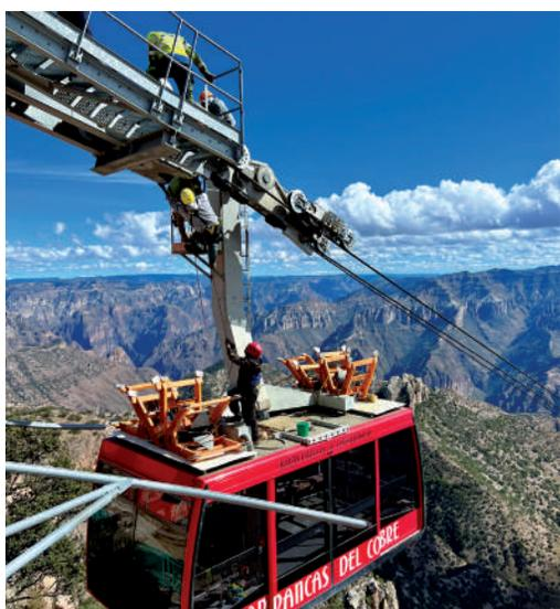
Dicho estudio conllevó la reconstrucción de un escenario de ensayo que representara las características más peculiares del sistema de transporte por cable de tipo telecabina, para realizar una serie de mediciones en condiciones realísticas, y así definir un valor mínimo de tiempo para desalojar las góndolas aéreas según el rigor científico.
